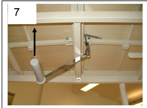
Lyft handtaget något uppåt, samtidigt som du trycker in fästkrokens övre del mellan det vita staget och träskivan.
