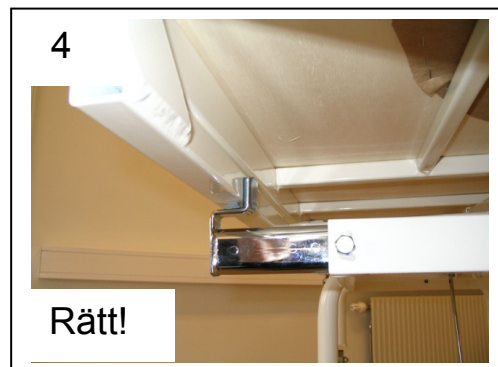
Skruva loss och anpassa fästena efter bredden på din bänk. OBS! Se till att fästet sticker ut lika mycket på båda sidor så att bänken är centrerad. Dra åt med blocknyckel 13 mm
