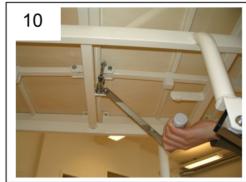
Lyft handtaget upp som bild 11 visar. Om det nästan inte går att trycka upp handtaget hela vägen eller om bänken inte verkar spänns fast ordentligt, reglera då detta genom att skruva kroken ut eller in.
